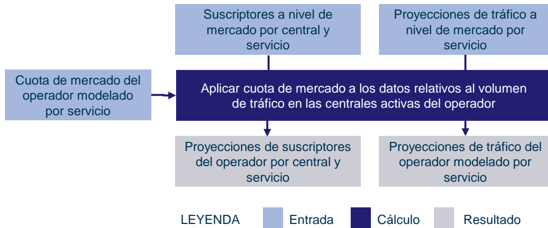
Figura 5.27: Esquema de la metodología empleada para extrapolar las proyecciones de tráfico y el número de suscriptores al caso del operador modelado [Fuente: Analysys Mason, 2012]
